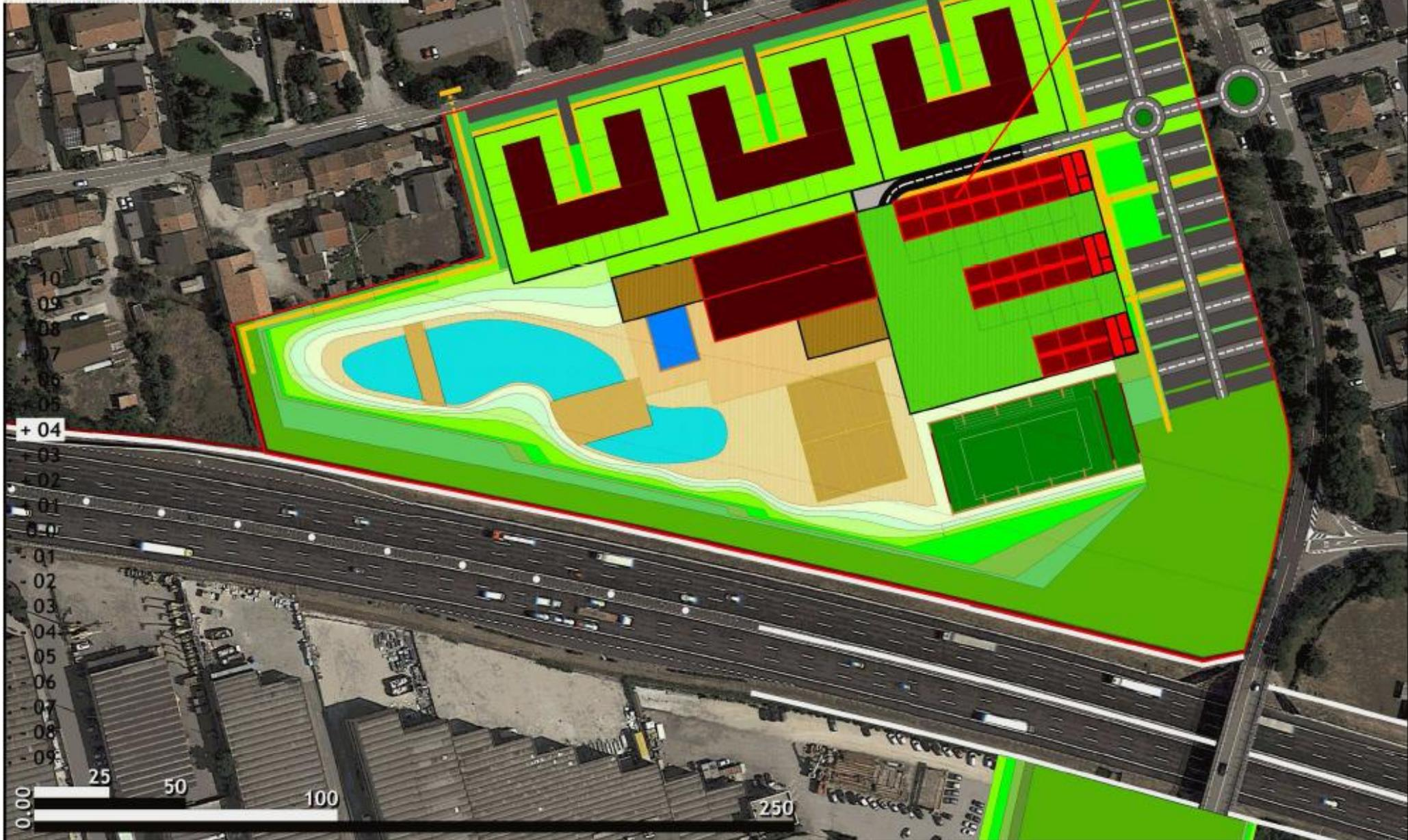
Alla quota + 6 viene realizzato il nuovo accesso viario da Via Villa per poter servire i parcheggi realizzati in quest'area. Alla quota + 8 viene realizzato il sistema di copertura della "Galleria Artificiale" da realizzarsi sull'Autostrada "A4".
