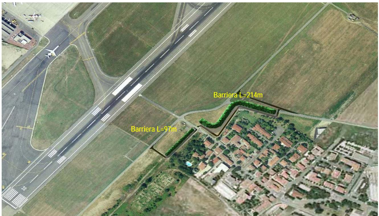
Fig. 6 Localizzazione delle barriere antirumore
