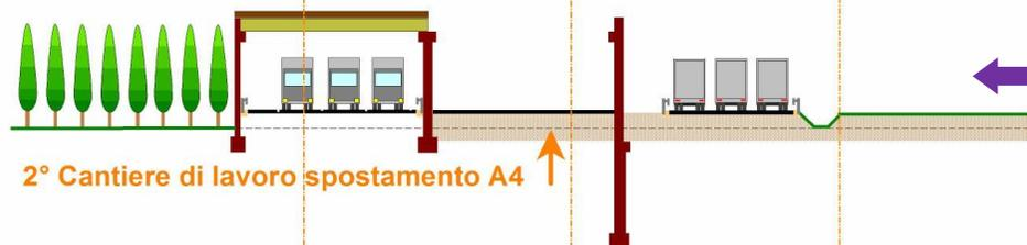
Sezione che evidenzia la posizione del 2° Cantiere, da aprire per riuscire a realizzare lo spostamento verso Sud della Corsia NORD dell'Autostrada "A4" senza mai interrompere il traffico.
