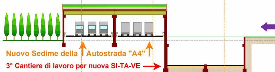
Sezione che evidenzia la posizione del 3° Cantiere, da aprire a nord della nuova Galleria Artificiale dove viene trasferito il traffico dell'A4 al fine di poter iniziare i lavori per la realizzazione della nuova Autostrada: SI-TA-VE.
