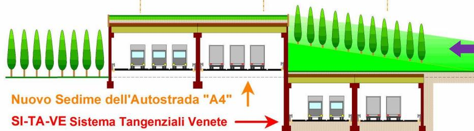
Sezione finale dell'A4 e della SI-TA-VE che evidenzia come le due autostrade possano essere realizzate una (l'A4) in Galleria Artificiale e la seconda (la SI-TA-VE) in Trincea Coperta, con Impatto Ambientale... "a Zero"... sul centro abitato di Caselle.
