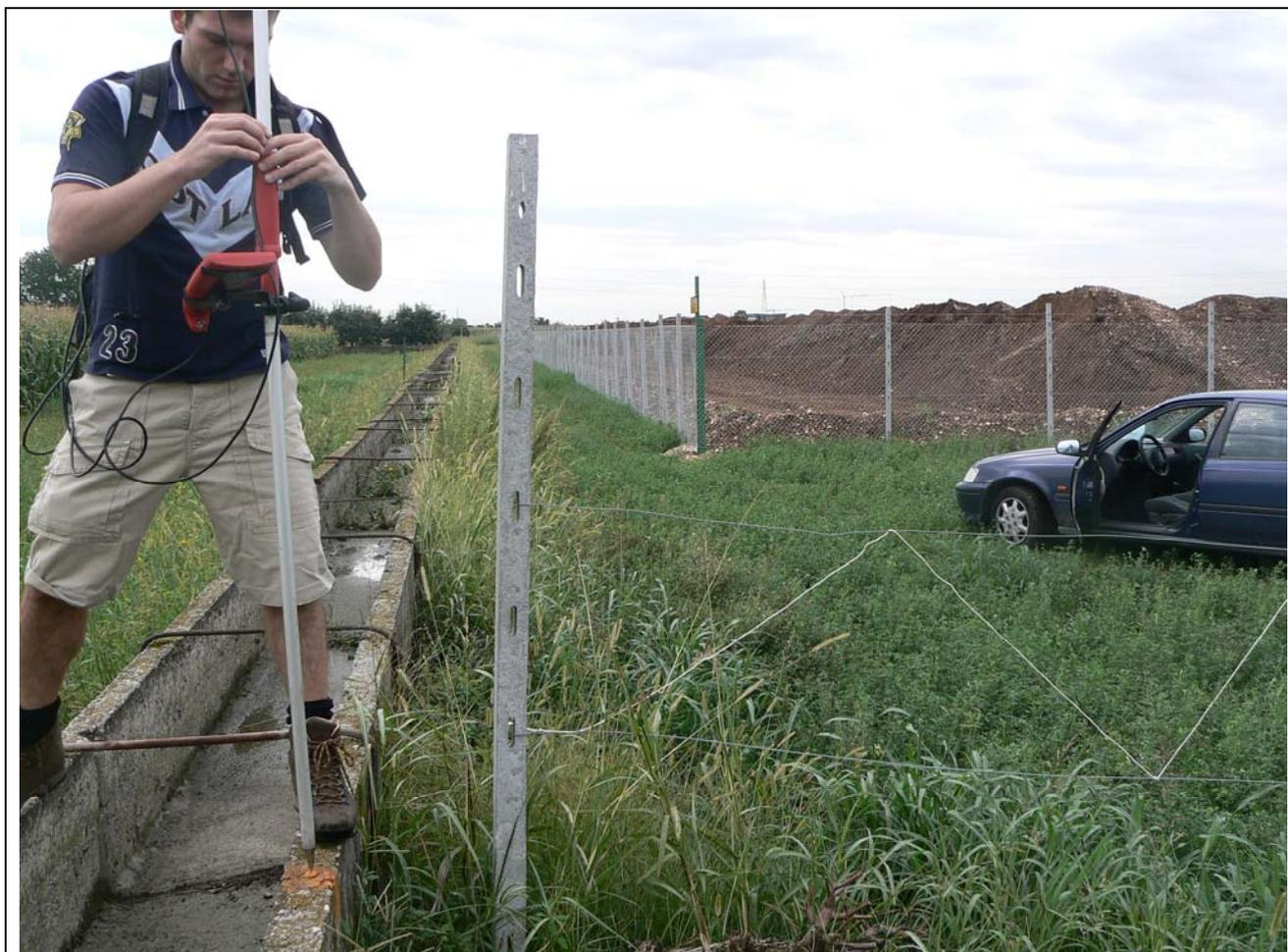
FOTO N. 5: Caposaldo trigonometrico CP001, ubicato a Nord Est del perimetro di cava, costituito da chiodo con rondella infisso sulla sponda in cls della canaletta irrigua. Coordinate (Gauss-Boaga, Fuso Ovest) Nord 5031982, Est 1647579, Quota 87,557 m s.l.m.
