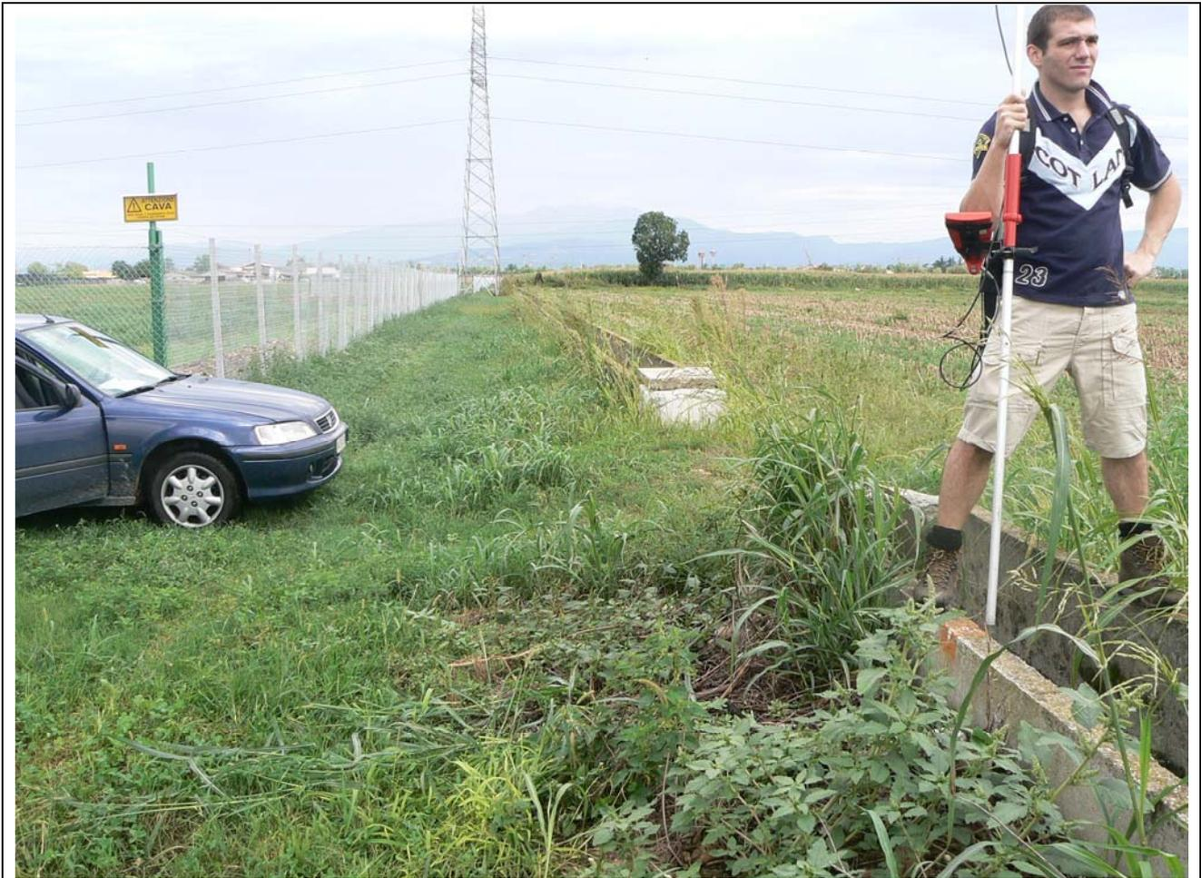
FOTO N. 6: Caposaldo trigonometrico CP002, ubicato a Sud Est del perimetro di cava, costituito da chiodo con rondella infisso sulla sponda in cls della canaletta irrigua. Coordinate (Gauss-Boaga, Fuso Ovest) Nord 5031308, Est 1647612, Quota 84,455 m s.l.m.
