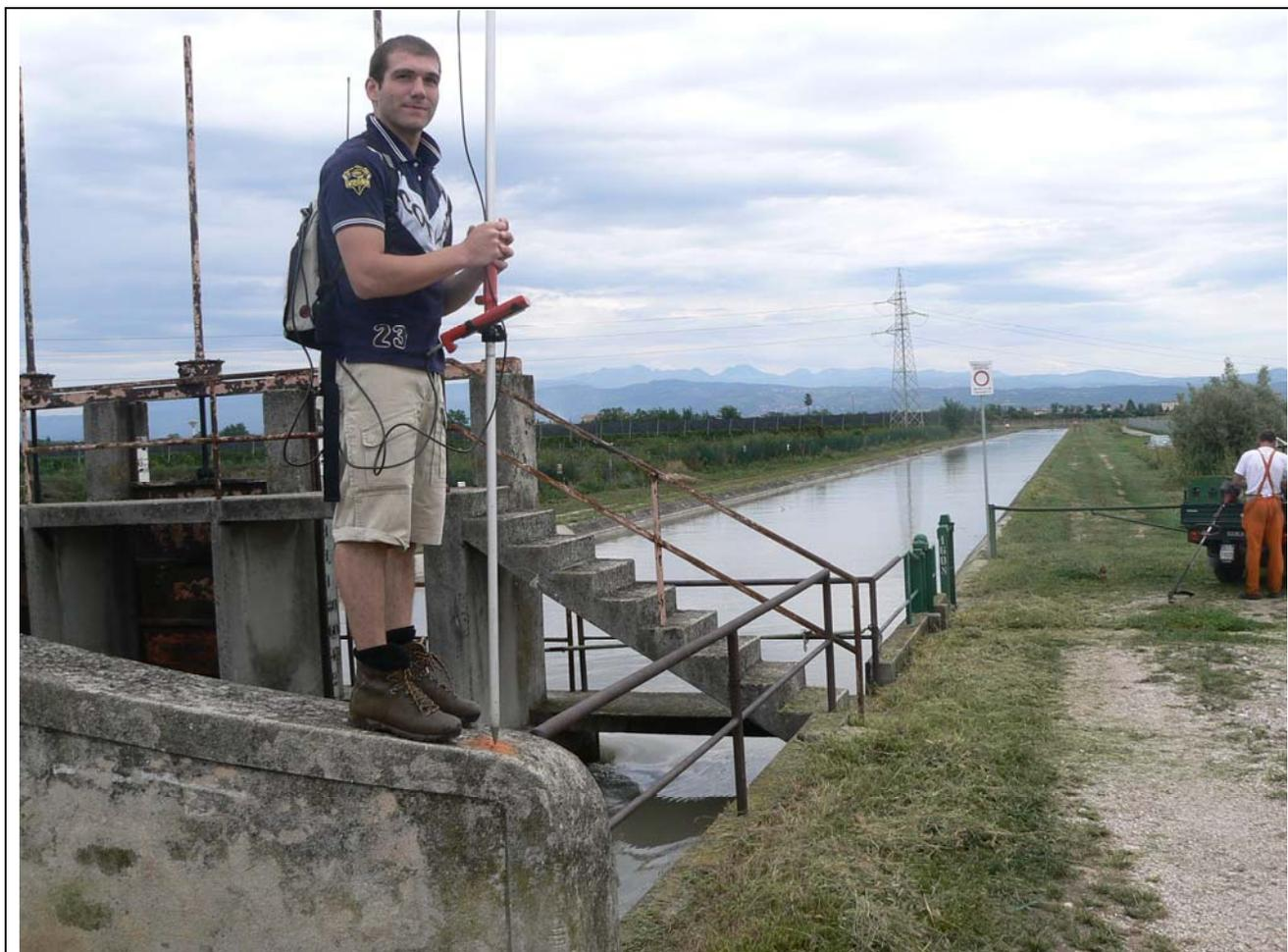
FOTO N. 7: Caposaldo trigonometrico CP003, ubicato a Sud Ovest del perimetro di cava, costituito da chiodo con rondella infisso sulla spalla sinistra del ponte di attraversamento del canale consortile. Coordinate (Gauss-Boaga, Fuso Ovest) Nord 5031396, Est 1647152, Quota 87,684 m s.l.m.
