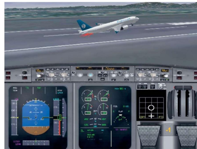
Ricostruzione simulata, realizzata nei laboratori ANSV (software Insight Animation V3), dell'impatto della coda durante la corsa di decollo, utilizzando i dati scaricati dal Flight Data Recorder.
