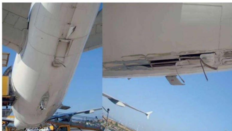
Aeromobile LZ-BHC: estesi danneggiamenti strutturali nella parte inferiore della fusoliera.
